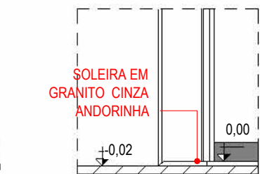
DETALHE DO DESNIVEL DA SOLEIRA
